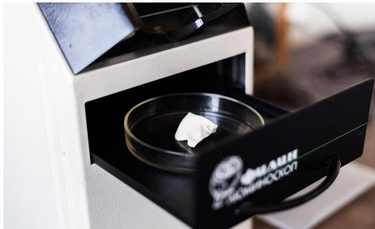
Содержание битумоидов в исследуемой пробе оценивается по пятибалльной системе, исходя из морфологии и интенсивности свечения отпечатка капиллярной вытяжки на фильтровальной бумаге под люминесцентным микроскопом.
